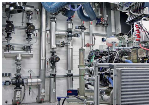
Die Heiz- und Kühlkreisläufe mit Pumpen für die Medienkonditionierung
