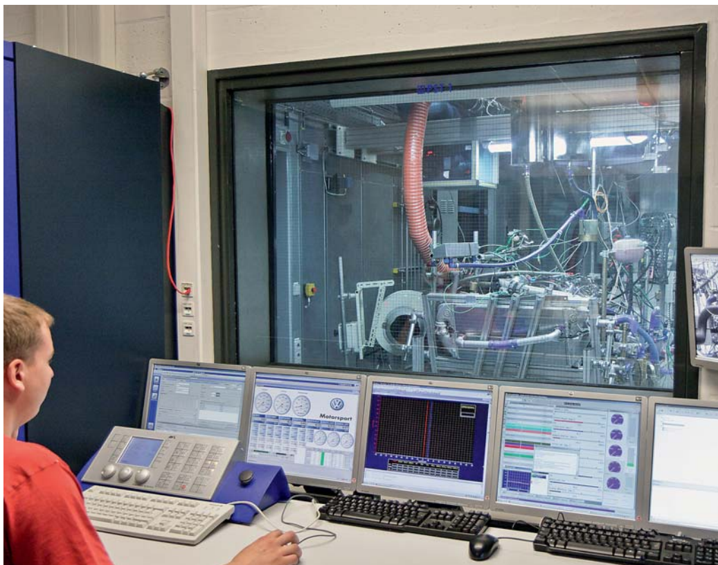
Um die laufenden Prozesse stets im Blick zu haben, nutzen die Motorexperthen von Volkswagen die Beckhoff-Visualisierungssoftware TwinCAT HMI CE.
